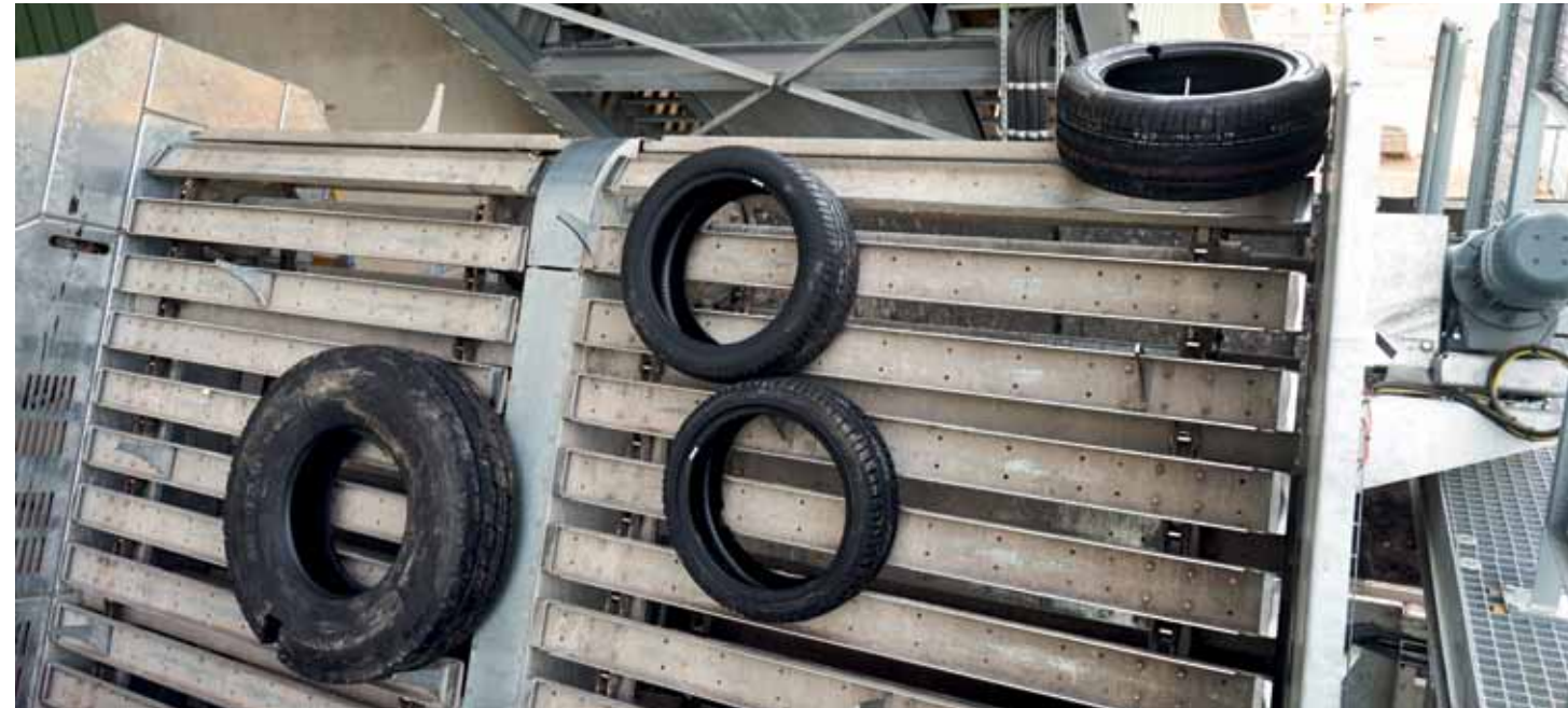
Kanca ayırıcı, lastiklerin üst üste istiflenmemesini sağlar.
