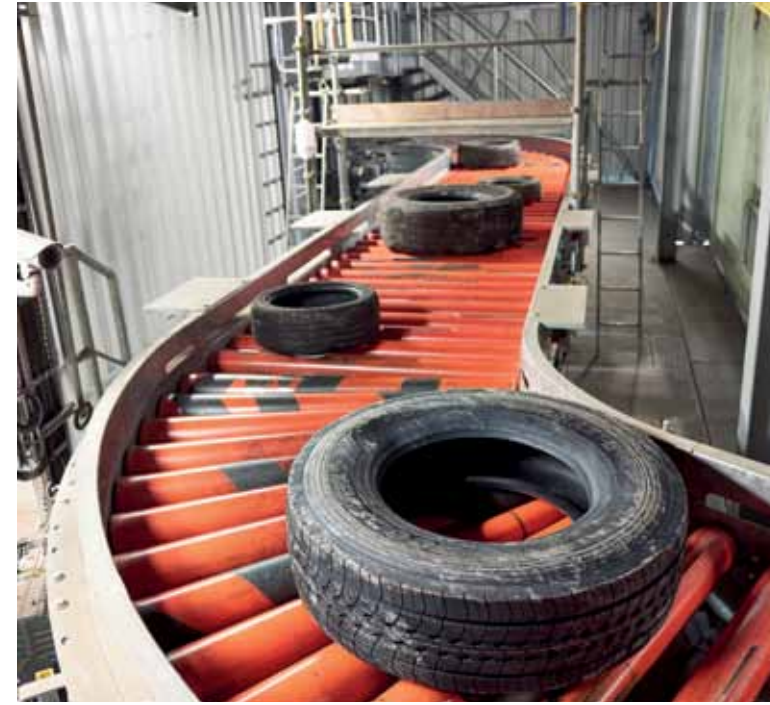
Birbiri ardına lastikler. Makaralı konveyör, lastikleri ayrı istasyonlara yönlendirir.
