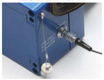
CONNECT THE PLUG TO THE SOCKET THE RED LINE ON THE PLUG AND SOCKET SHOULD BE IN THE SAME POSITION!
